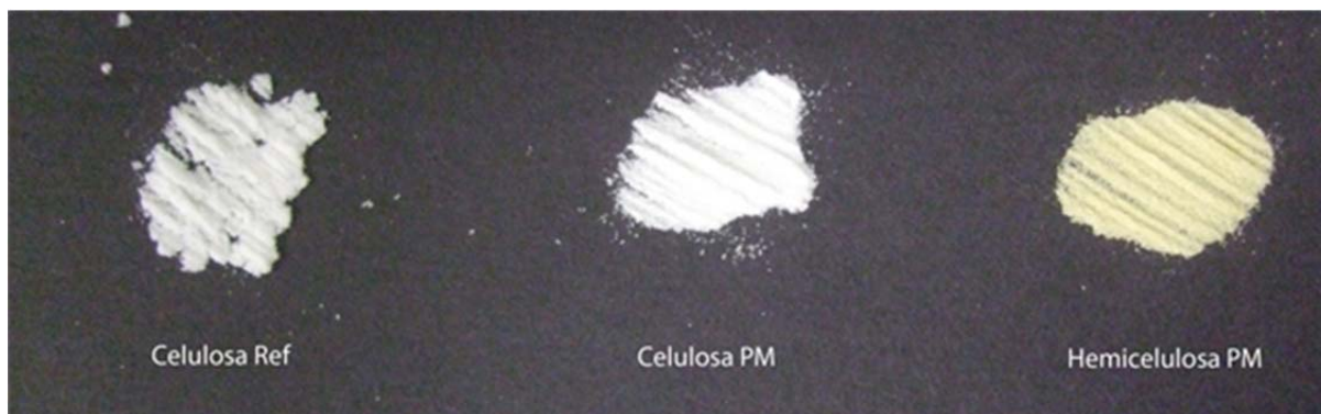
Figura 5. A) Celulosa de referencia, B) celulosa y C) hemicelulosa, aisladas de la cáscara de plátano macho.
