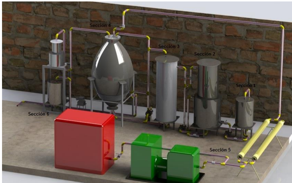
Figura 5. Planta piloto de tratamiento térmico-anaerobio de lodos residuales
