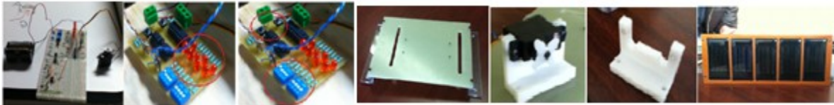
Figura 3. Circuito electrónico prototipo. a) Circuito electrónico prototipo en fase experimental. b) Leds de posicionamiento. c) Micro-interruptores de selección de posición del servo. d) Base del prototipo. e) Servo motor montado. f) Base servomotor de material delrin. g) Celdas solares mono-cristalinas montadas.
