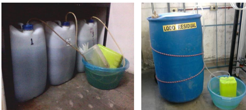
Figura 4. Bioreactores económicos de 50 L y 200 L de capacidad
