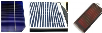
Fig 1. Celdas solares de silicón. a) Celda Mono-cristalina. b) Celda Poli-cristalina. c) Celda Amorfa
