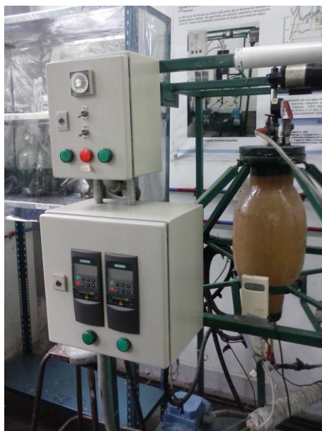
Figura 1. Bioreactor ovoide de 8 L de capacidad generador del biosolido
