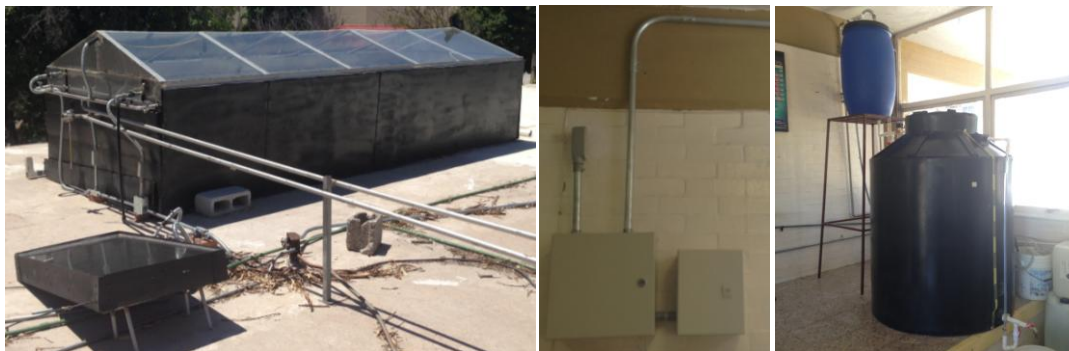
Fig. 3. Prototipo terminado de destilador solar de alto rendimiento con canalización y cableado del sistema de instrumentación y la etapa de precalentamiento.
