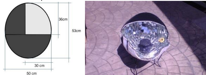
Figura 2. Dimensiones y arreglo para evaluar el prototipo
