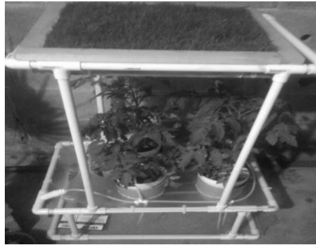
Figura 6. Prototipo del sistema de riego con tuberías.
