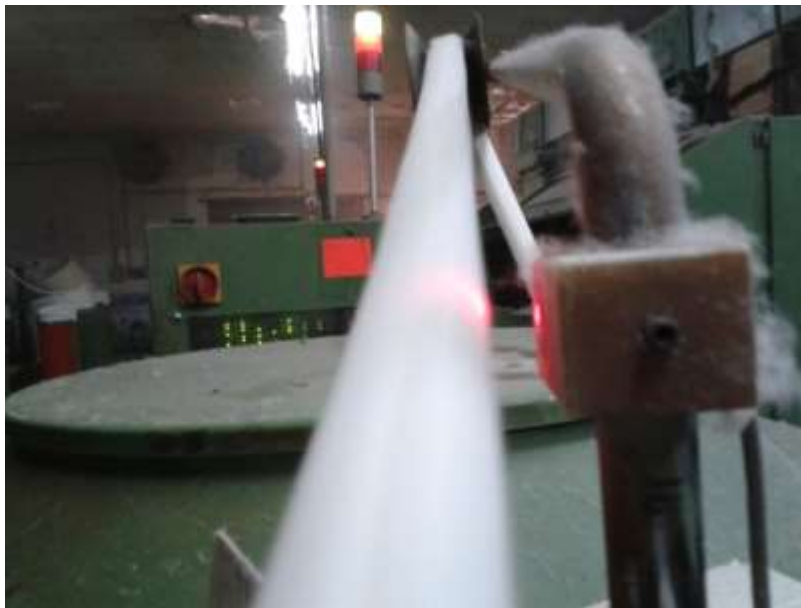
Fig. 4 Tira de algodón en la carda, como se puede apreciar la producción del hilo es constante y muy rápido es su paso por el sensor óptico en el cual se puede apreciar que se llena de pelusa, impidiendo que se puedan detectar las fallas que pueda presentar el hilo, provocando de esta manera incluso su ruptura
