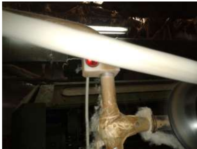
Fig. 6 Como se puede apreciar el sensor de proximidad por medio de leds, detectara la calidad del hilo, apreciando su volumen adecuado y su peso.
