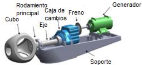
Figura 2. Sistema de coordenadas de las hélices de la turbina eólica [13]. con caja de engranes y generador acoplado [14].
