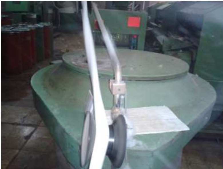
Fig. 3 Prototipo de proximidad infrarrojo CNY70, como se puede apreciar en la foto, el lector de leds, se encuentra a un cm de distancia de las tiras de algodón que se transportan a lo largo de la carda, con la finalidad de una adecuada obtención del hilo.
