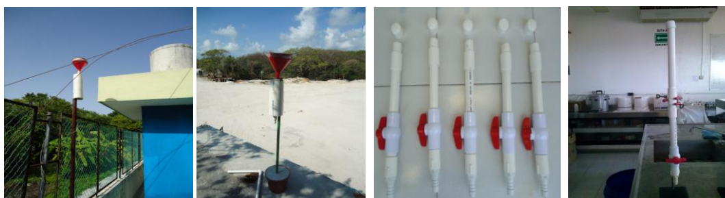
Figura 2. Sistema de muestreo pasivo y dispositivo utilizado para realizar la extracción de los tubos de resina.
