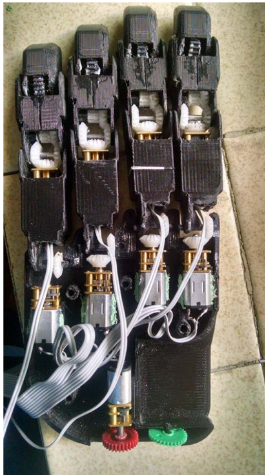
Figura 3 diseño mecánico de la mano, vista interior
