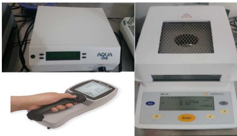
Figura 1. Equipos para la determinación de humedad, aw y color.
