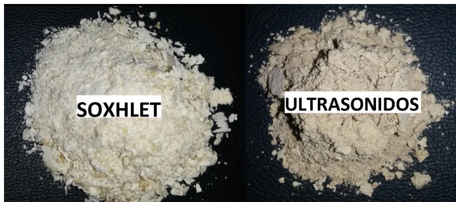
Figura 3. Comparación de cera extraída por los métodos de Soxhlet y Ultrasonido
