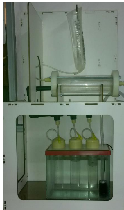
Figura 1. Diagrama esquemático y fotografía del reactor anaerobio en configuración en paralelo
