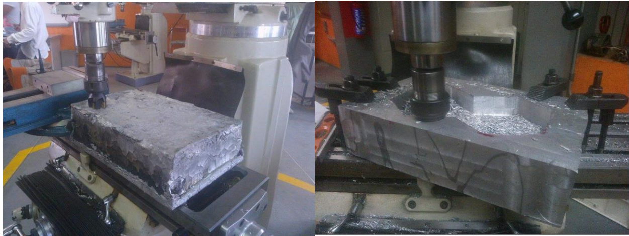
Figura 4. Maquinado de molde de inyección para elaboración del adoquín.
