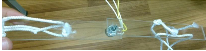
Fig. 5. Goniómetro desarrollado a partir del potenciómetro.
