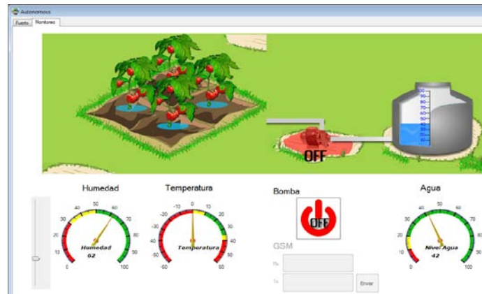
Figura 10. Interfaz gráfica de tiempo real en el monitoreo de humedad y nivel de agua en la cisterna
