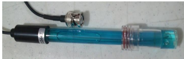
Figura 3. Sonda de pH. Funciona creando un pequeño voltaje entre el líquido a medir y la sustancia dentro de la sonda.
