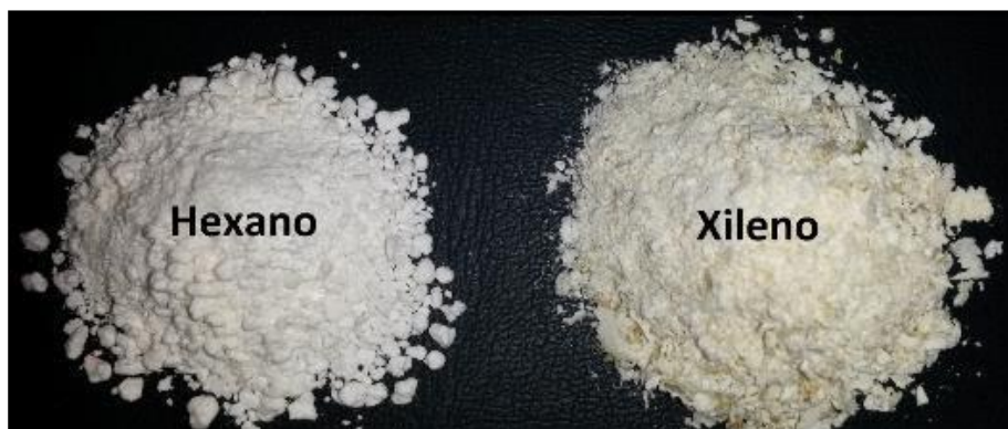
Figura 1. Cera de grana cochinilla cristalizada utilizando Hexano y Xileno.
