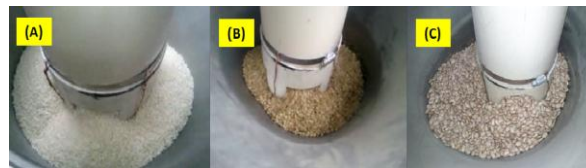
Figura 6. Pruebas piloto dosificador, arroz (A), garbanzo (B) y frijol (C).
