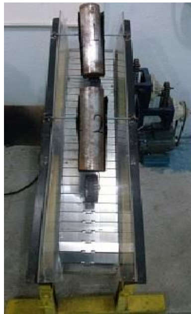
Figura 1. Banda transportadora de paletas con los aditamentos para simular cargas.
