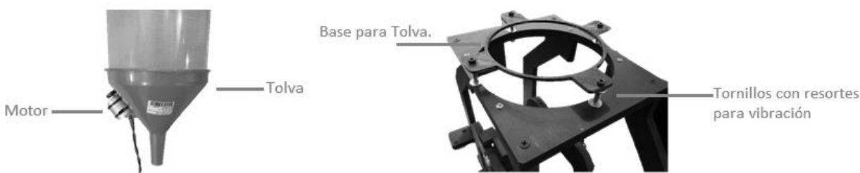
Figura 2. Sistema de vibración motorizada y resortes.
