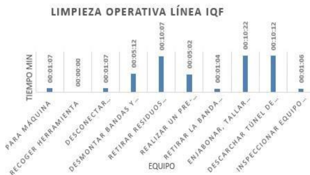
Grafica 3. Tiempo promedio por equipo en limpieza operativa de la línea IQF.
