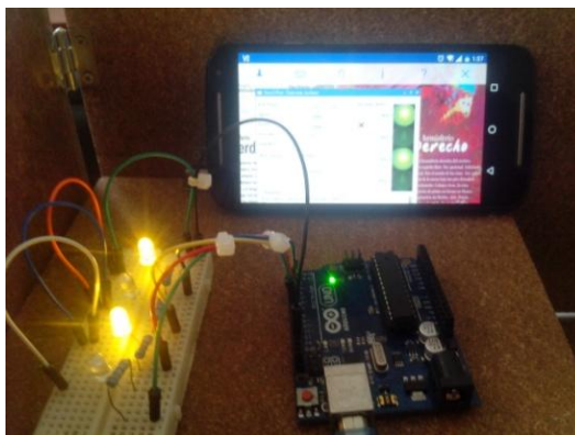
Figura 7. Conexión serial Arduino-Raspberry, por medio del protocolo VNC gestionado por medio del celular
