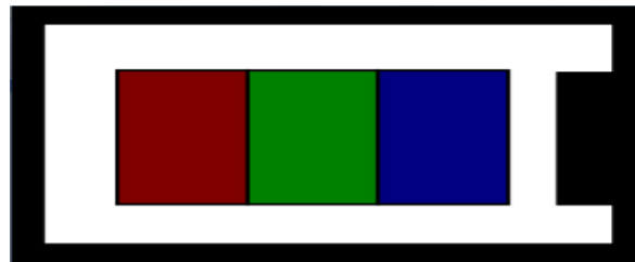
Figura 1 Calibrador. La marca derecha del calibrador en color negro permite saber la orientación Los colores dentro del calibrador permiten calcular la distorsión del color por iluminación Las proporciones rectangulares del calibrador permiten conocer la distorsión provocada por la posición
