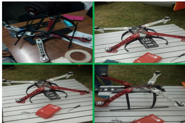
Figura 5. Ensamble de la estructura (brazos, frame inferior, motores, variadores de velocidad y tren de aterrizaje).
