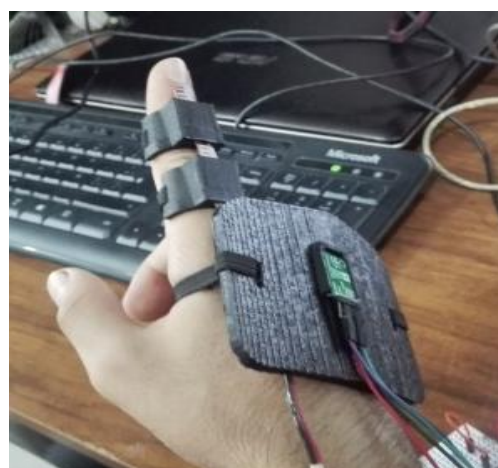
Figura 9. Sensores instalados en sus bases
