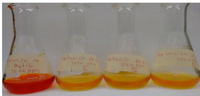
Figura 4. Comparación de solución acuosa a 1.0 g/L de concentración de naranja de metilo después de agitación a 40 minutos.
