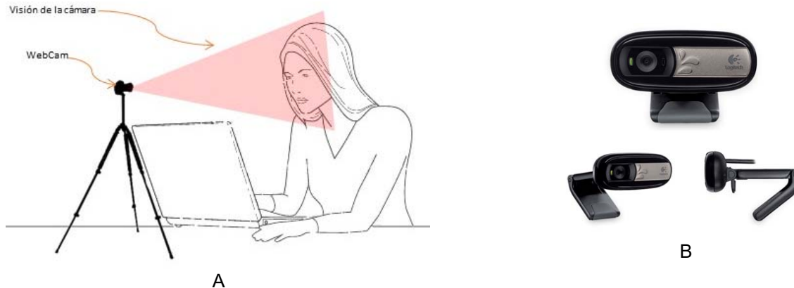
Figura 5. A. Se observa la colocación de la cámara en el usuario, montada en un tripié de frente al rostro. B. Cámara utilizada en este algoritmo.
