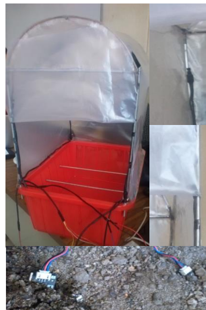
Figura 4. Prototipo de invernadero y sensores utilizados
