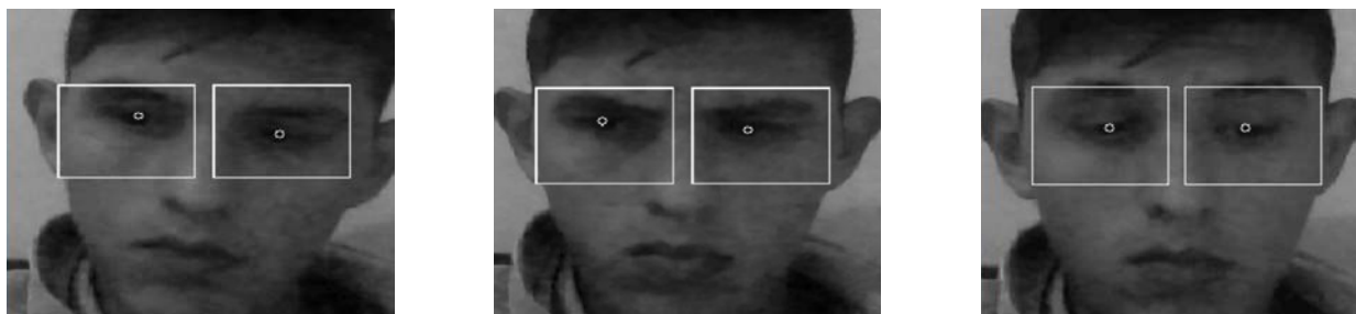
Figura 6. Ejemplo de tomas en diferentes tiempos de captura, donde se muestra al sujeto teniendo una identificación positiva de los ojos y su centro.
