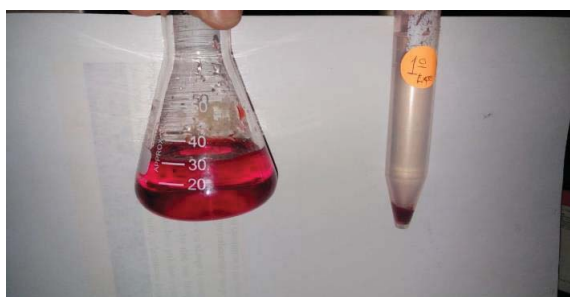
Figura 6. Remoción de color en la solución acuosa al finalizar una prueba de adsorción
