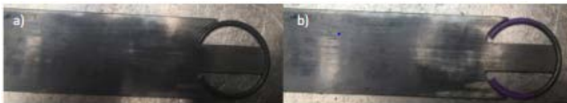
Fig. 11 a) Seguro correcto b) Seguro con una abertura mayor al correcto.
