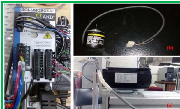
Figura 3. a) Servo Drive; b) Codificador; c) Servo Motor.
