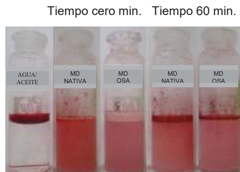
Figura 1.- Emulsiones preparadas con 1.5 g de MD-OSA y MD, con 1 ml aceite de aguacate. Agitación por 8 min a 22,000 RPM, al tiempo cero y con 60 minutos de reposo.
