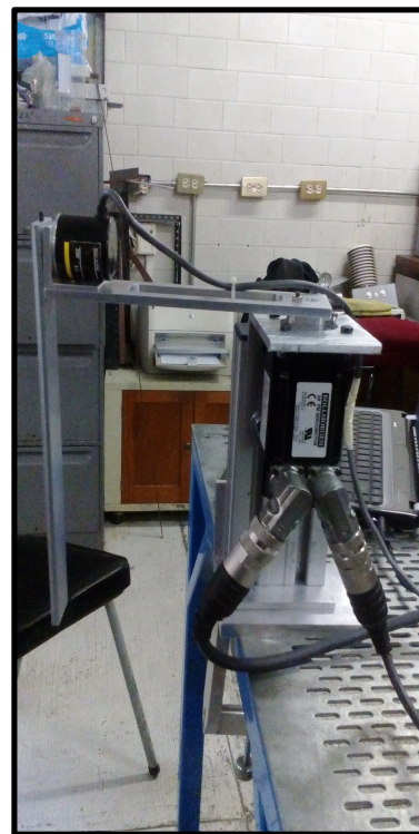
Figura 7. Sistema mecánico subactuado en configuración Furuta.
