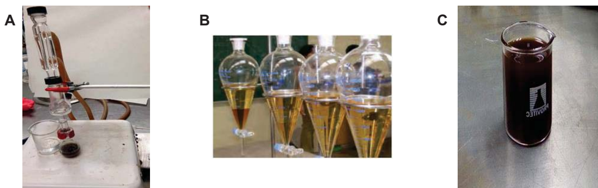
Figura 3. Transesterificación: A) Reacción de Transesterificación; B) Decantación del biodiesel; C) Biodiesel purificado.
