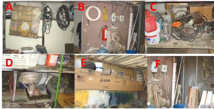
Figura 3. Taller de Mantenimiento antes de las 5 s. (A espacio para bandas, B tubería plástica, C desengrasantes/abrasivos, D cables, E Carpintería/pinturas, F conectores y tuberías de cobre)
