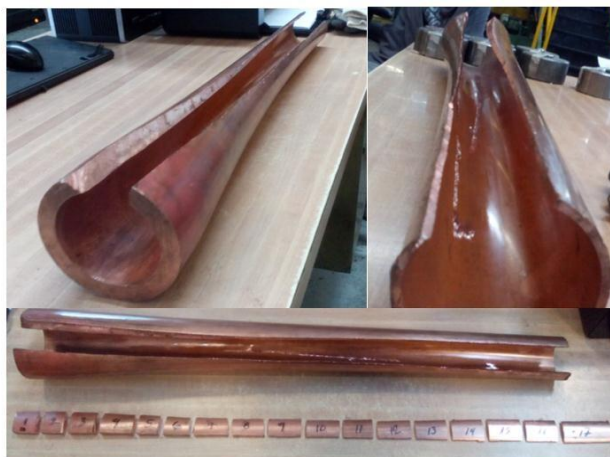
Figura 5. Cono de laminación y muestras en las que se dividió para evaluar secciones.
