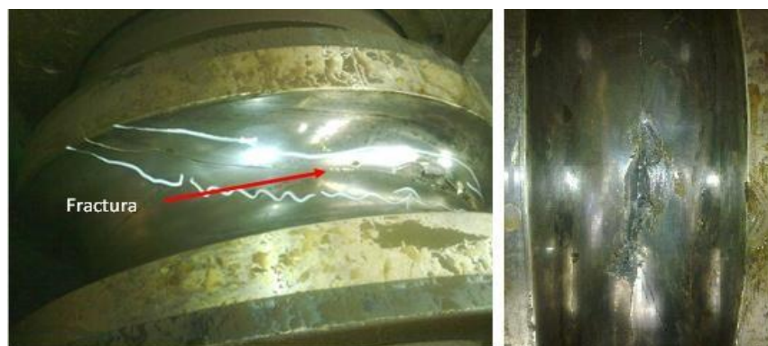
Figura 3. Rodillo de laminación fracturado.
