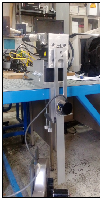
Figura 6. Sistema mecánico subactuado en configuración Pendubot.
