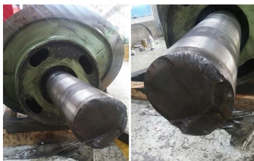
Figura 2. Falla en la flecha
