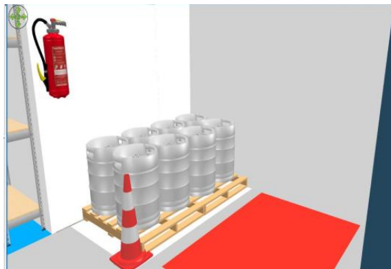
Imagen 9.- NOM-002-STPS-1999. Se aprecia que existe la señalización de áreas, para prevenir accidentes, además de equipos contra incendios.
