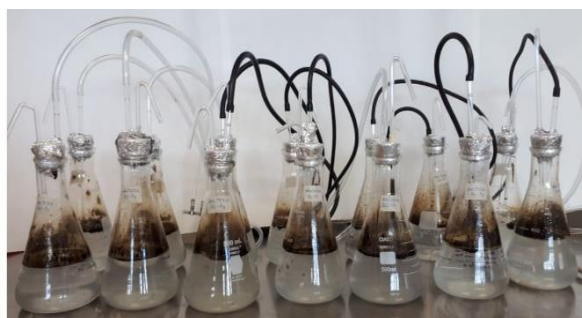
Figura 1. Células en medio de celulosa agar para bacterias degradadoras de hidrocarburos.
