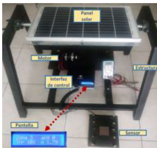
Figura 10. Sistemas integrados de posicionamiento automático a la posición de máxima radiación.
