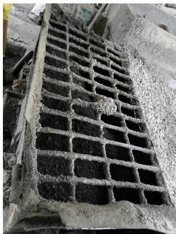
Figura 5 Tolva de suministro de 1m 3 de capacidad.
