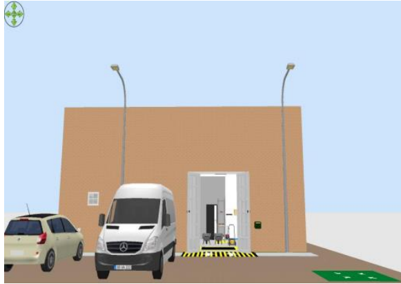
Imagen 8.- NOM-001-STPS-2008. Se aprecia la designación de espacios de seguridad del almacén, debido a que carecía de ello.
