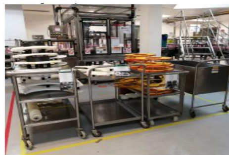
Fig. 4 Carros transportadores con herramental de 400 ml preparados para cambio de formatos: etiquetadora, volteador, llenadora y carro vacío para formato de llenadora
