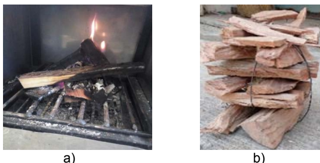
Figura 1. Arreglos iniciales de la biomasa, donde a) inquemados sin arreglo inicial y b) configuración de rejilla sujeta con alambre.
