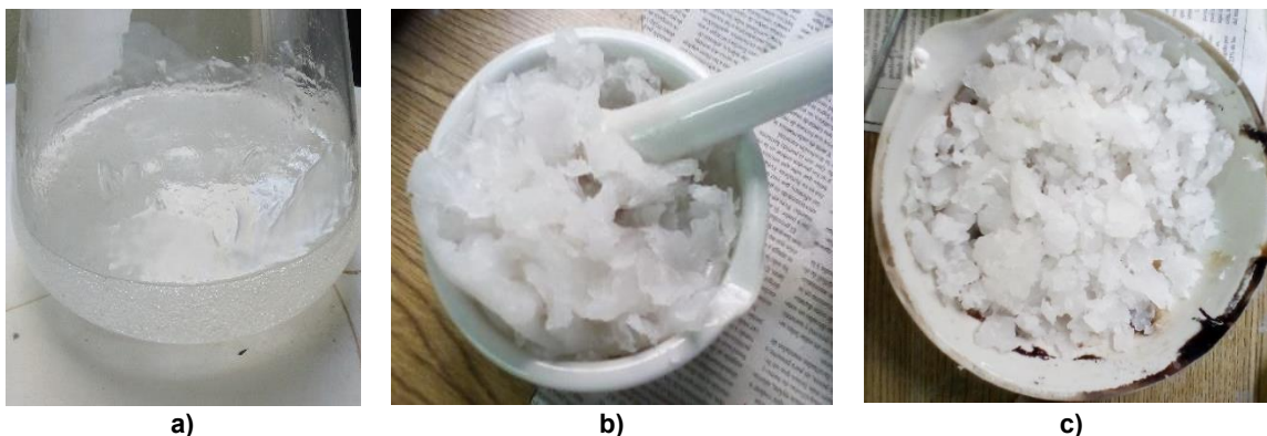
Figura 2: Polietileno durante las distintas etapas del proceso, a) Solvólisis terminada, b) Playo molido, c) Muestra final de PEBDL recuperado
