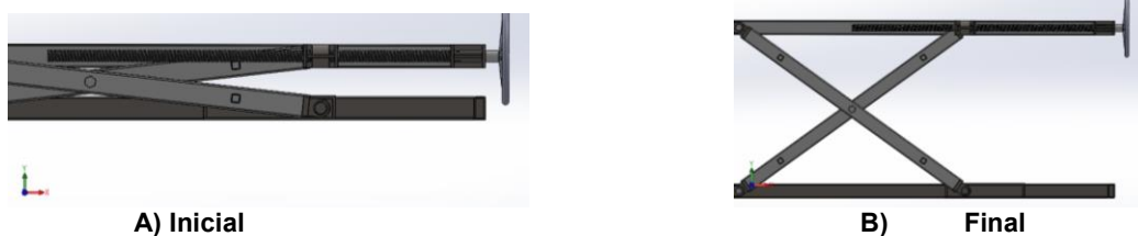
Figura 9. Posiciones de la estructura del elevador
