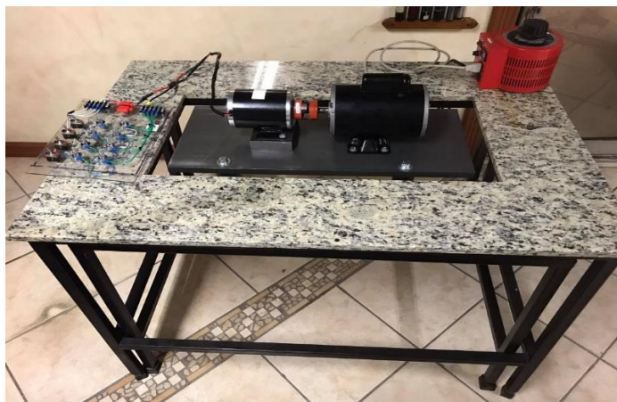
Figura No. 9 Integración del sistema de sujeción y carga en la mesa anti-vibratoria.
