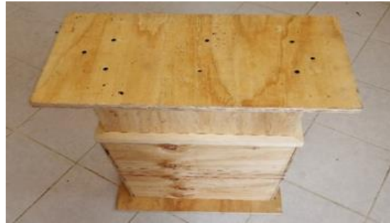
Figura 3. Molde de madera de encino para la creación de blocks.
