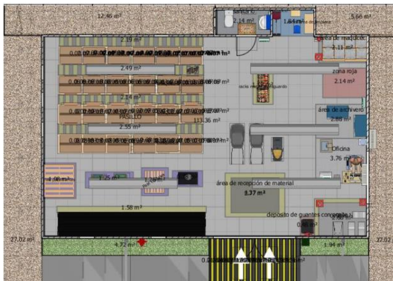
Imagen 7.- Layout Final. Diseñado realizado en Sweet Home 3D, el cual permitirá identificar los materiales con mayor eficiencia, y además se aplicaron las NOM como parte de la seguridad del personal en el almacén.
