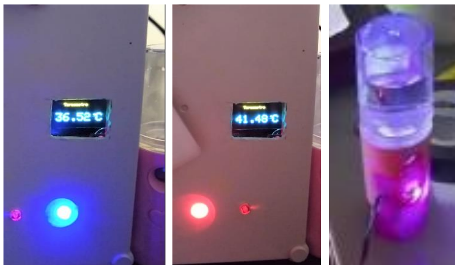
Figura 8. Pruebas de lectura del termómetro digital autónomo.
