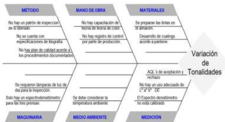
Gráfico 5. Diagrama de causa raíz, para análisis del problema de variación de tono en litografía.
