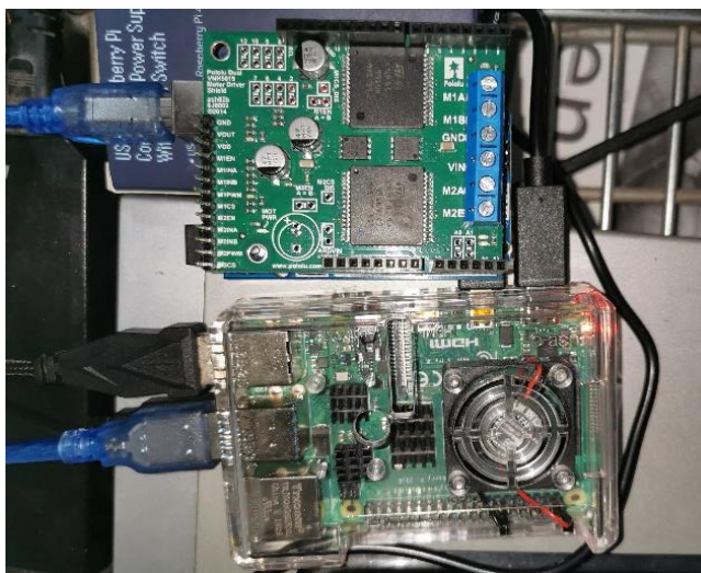
Ilustración 4. Comunicación entre la Raspberry Pi 4 y el driver pololu VNH5019 montado sobre el Arduino UNO
