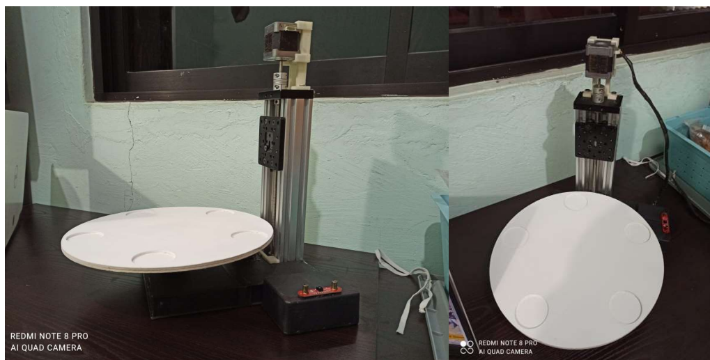
Figura 5. Implementación del sistema SILAR tipo carrusel
