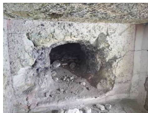
Figura 4. Aluminio adherido a refractario
