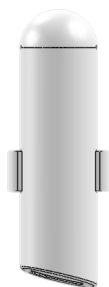
Figura 10 Modelo de botones: Estos son el componente más importante del dispositivo pues es el componente relacionado directamente con el aprendizaje de Braille para el niño con discapacidad visual. El dispositivo cuenta con seis botones como este.
