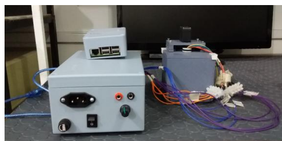
Figura 4. Sistema ensamblado constituido por el módulo de potencia, el módulo de contenedor/mecanismo de control de longitud de onda y el módulo de adquisición y procesamiento de datos.
