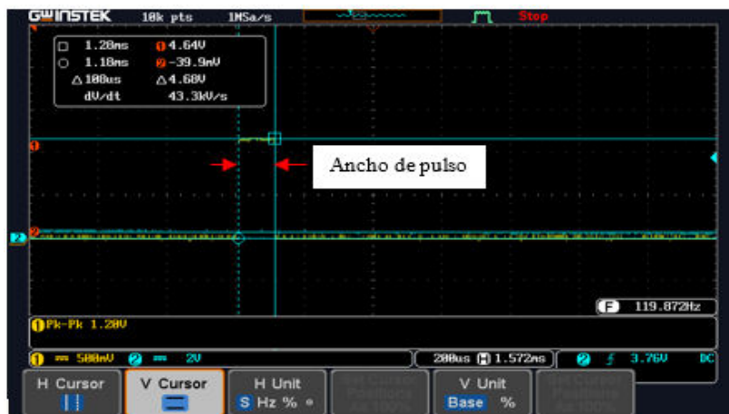
Figura 5. Pulso de aguja obtenido a la salida del Arduino Mega 2560.
