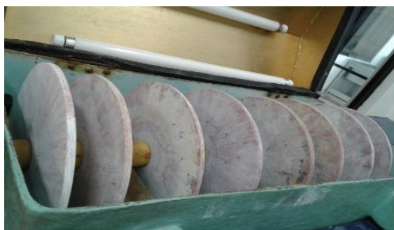
Figura 1. Reactor de fotodiscos rotativos equipado con lámparas de luz blanca.
