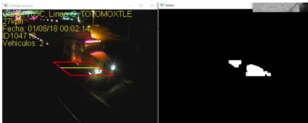
Ilustración 6. Detección de contornos aplicado en el software.
