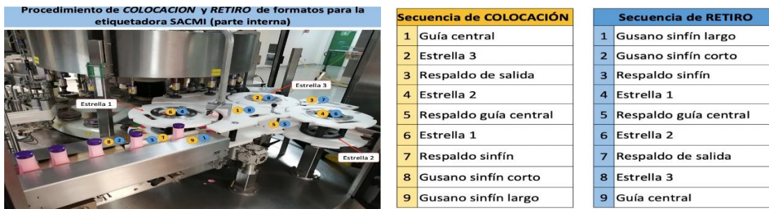
Figura 6. Visual de colocación y retiro de formatos (herramientales) para la etiquetadora SACMI.
