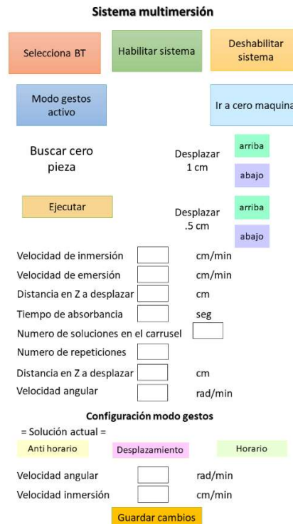
Figura 3. App móvil como tablero de control del sistema SILAR
