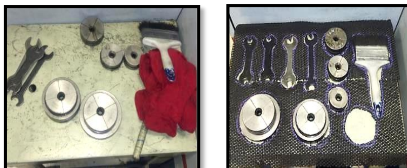
ANTES DESPUÉS Figura 4. Área de herramientas Antes-Después de Shadow Board
