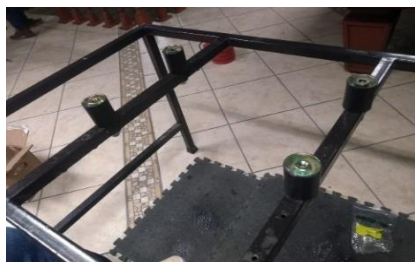
Figura No. 5. Aisladores de vibración (Soportes tipo sándwich e inserto).
