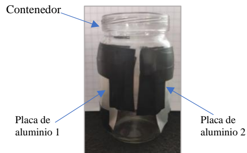
Figura 6 Frasco de vidrio con placas de aluminio en los laterales del frasco fijados con cinta de aislar.
