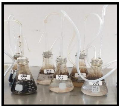
Figura. 1 Ensayo de emulsificación del petróleo
