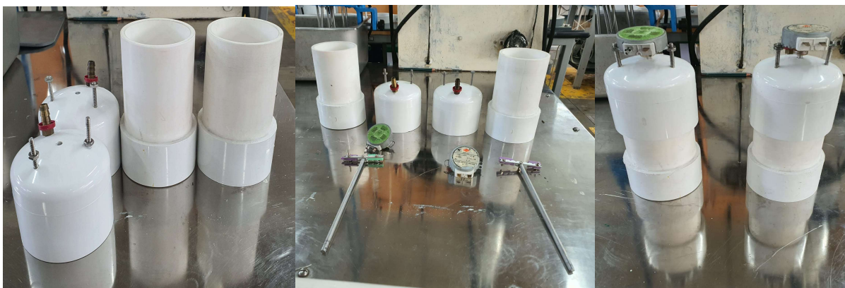
Figura 3. Aspectos de los materiales y etapas de construcción del evaporador utilizado en este estudio.
