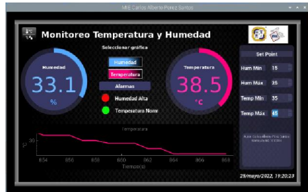
Figura 16. Interfaz gráfica funcionando a temperatura y humedad ambiente sin valores de puntos de ajuste. Mostrando gráfica de la temperatura.
