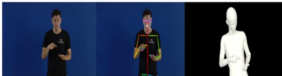
Figura 9 Generación de modelo 3D a partir de un video. Fuente: elaboración propia utilizando video público de la web, openpose y simplify-x
