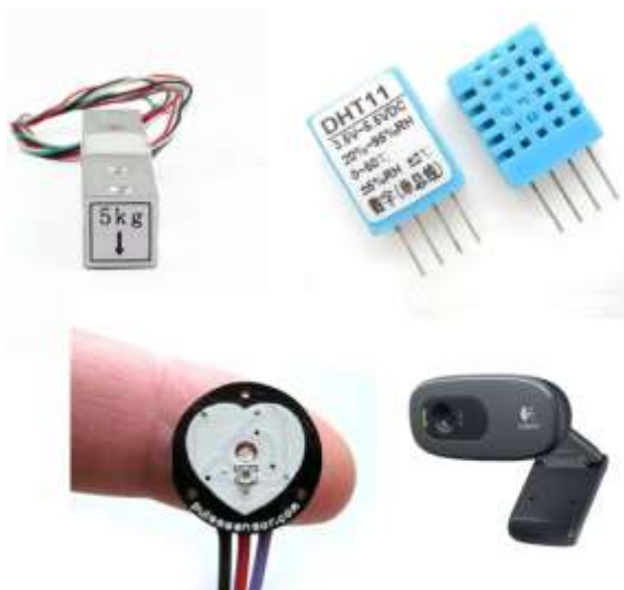
Figura 3: Sensores y cámara web empleados en el prototipo
