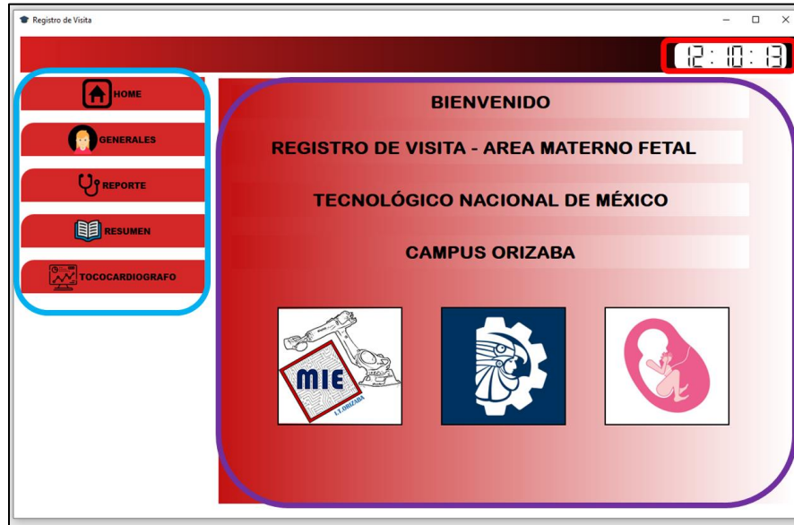
Figura 5. GUI desarrollada, en esta se observan los elementos que la conforman y la ventana de bienvenida. En el recuadro azul se observa el panel de control de la GUI, remarcado con color rojo la visualización de la hora local y de color morado el área de visualización y captura de datos.
