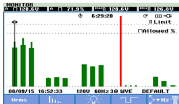
Figura 1. Sags capturadas por el analizador de redes eléctricas.
