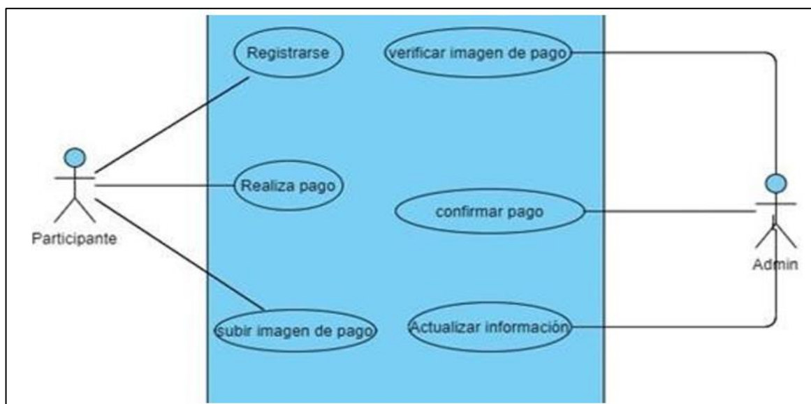
Figura 2. Diagrama UML de casos de uso del primer módulo. Fuente: Elaboración propia
