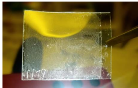
Figura 1. Película polimérica de PMMA obtenida por la técnica de spin coating.
