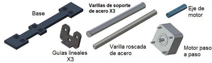
Figura 2. Vista artística de las piezas utilizadas para construir el eje de la máquina CNC.
