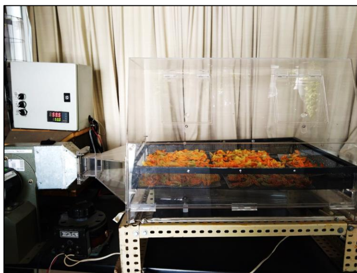
Figura 2 Proceso de secado convectivo de flor de calabaza
