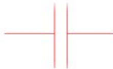
Figura 2 Símbolo eléctrico del capacitor.
