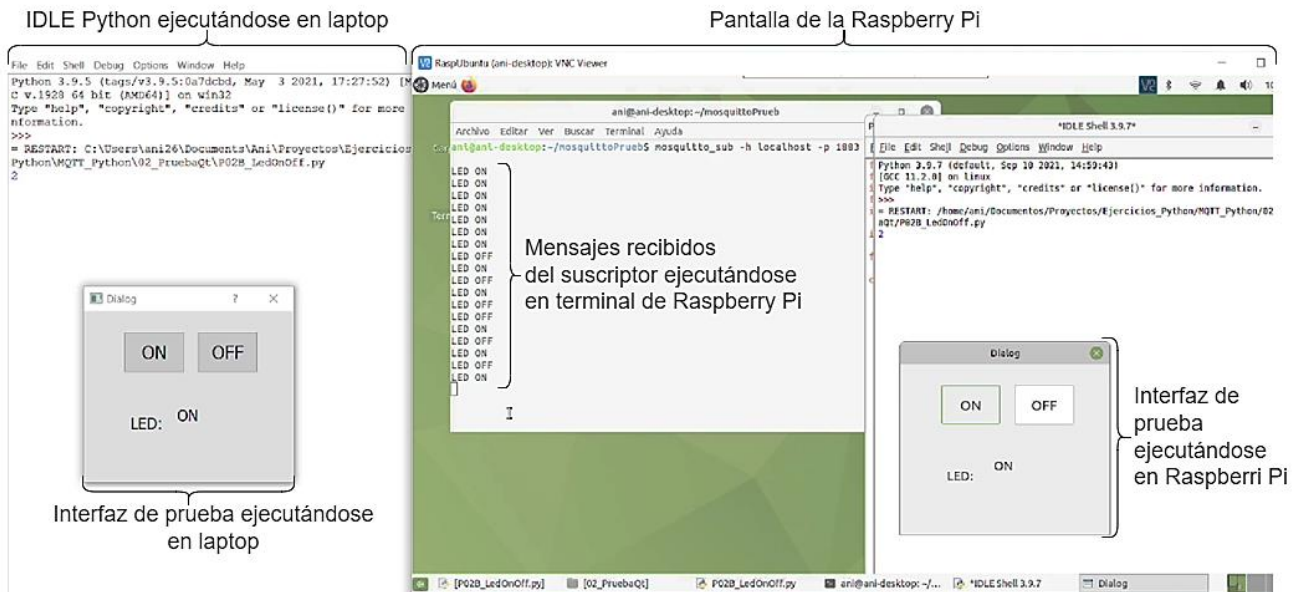
Figura 9.- Comunicación MQTT entre dos computadoras.
