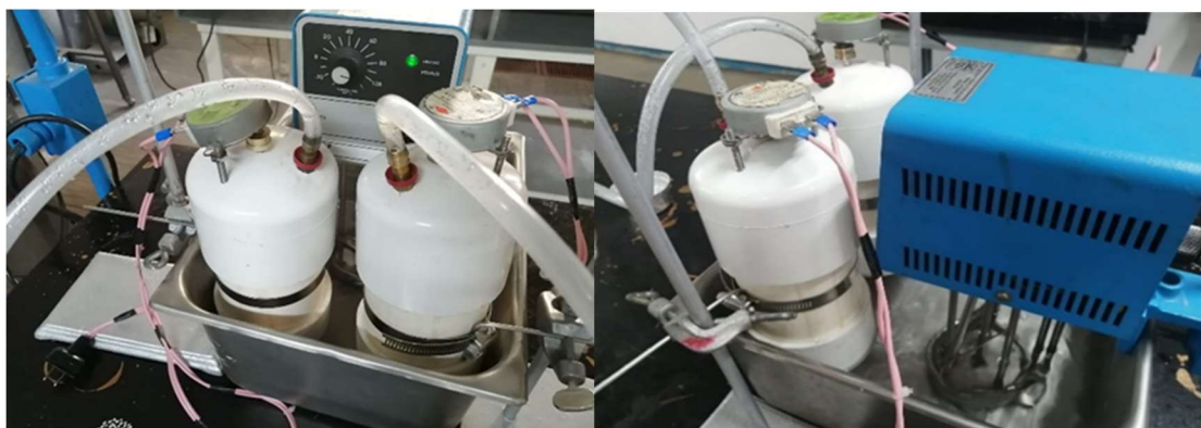
Figura 4. Aspecto de la disposición de los evaporadores construidos durante el proceso de concentración de jugo de melón.
