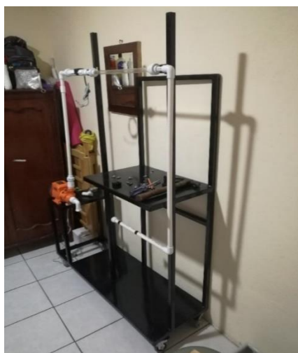
Figura 1.3 Montaje de tubería PVC.
