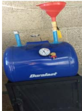
Figura 2. Sistema de generación de vapor que incluye cámara de combustión, válvulas e instrumentos de medición para las pruebas.
