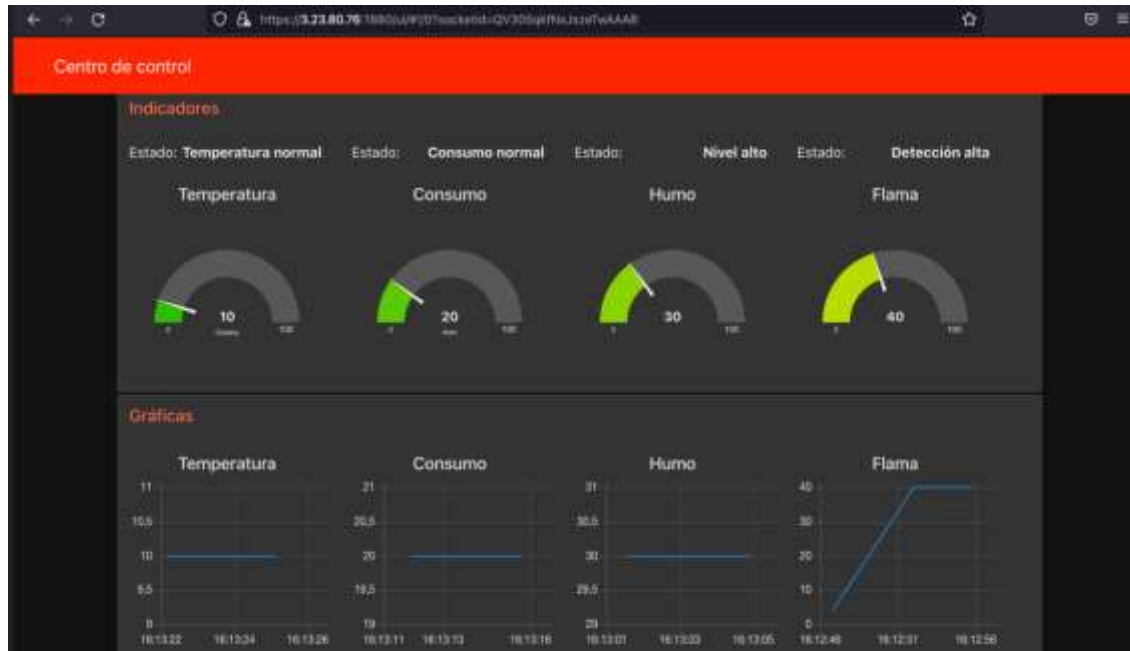
Figura 8. Representación grafica de los datos de los sensores en el dashboard.
