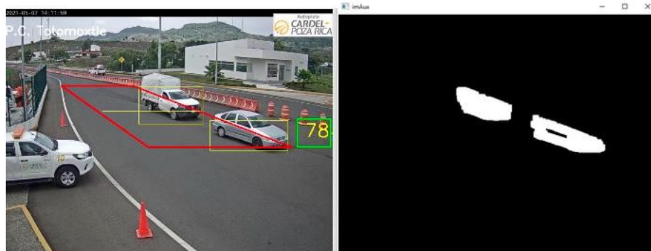
Ilustración 7. Imágenes obtenidas con la aplicación propuesta utilizando el método de substracción de fondo.
