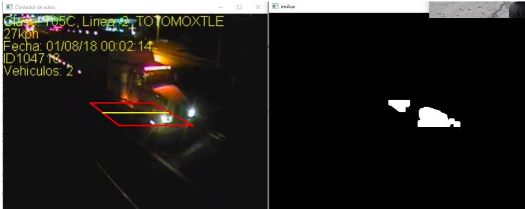
Ilustración 6. Detección de contornos aplicado en el software.
