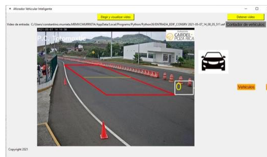
Ilustración 5. Área de detección de vehículos redimensionada
