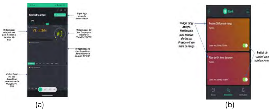
Figura 8. (a) Blynk.app: configuraciones en modo desarrollador, (b) Blynk.app: configuración de notificaciones y alertas. Adaptado de [31].
